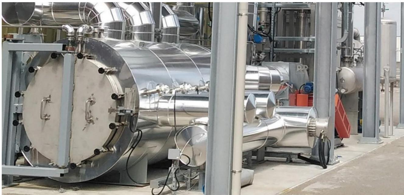
Prototipo industriale per il riciclo della vetroresina mediante processo di decomposizione termochimica
